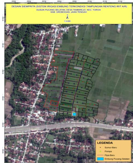
Gambar 5.58. Desain jaringan irigasi pada lahan sawah tadah hujan
